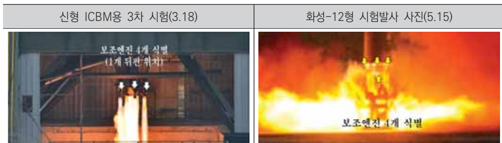
<그림 2-3> 3차 신형 대출력 엔진시험과 화성-12형 엔진 비교
