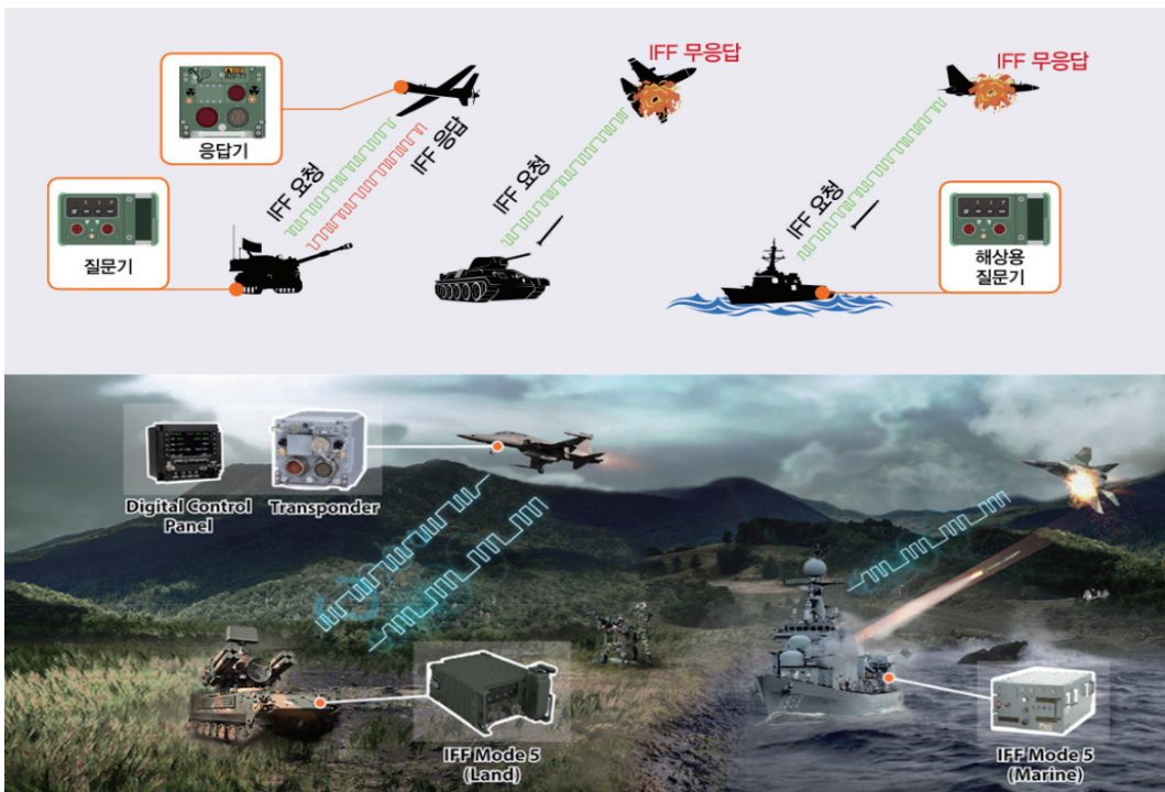
〈그림 2-4〉 IFF에 의한 피아 자동식별
