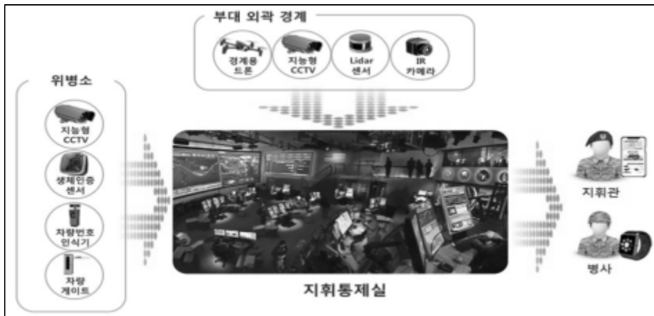
[그림 13] 지능형 경계감시 및 출입통제체계 구성도
